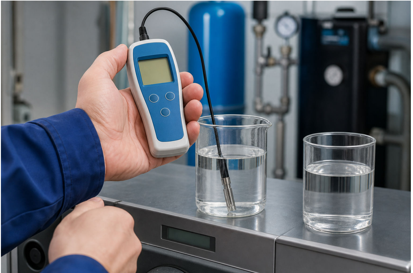
Techniker prüft die Leitfähigkeit von Heizungswasser mit einem digitalen Handmessgerät nach VDI 2035 · KI-generiert
